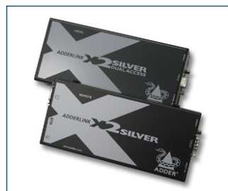
La prolunga KVM opzionale consente di collocare il monitor fino a 300 m dal computer.
