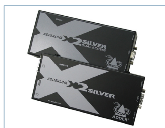
La prolunga KVM opzionale consente di collocare il monitor fino a 300 m dal computer.
